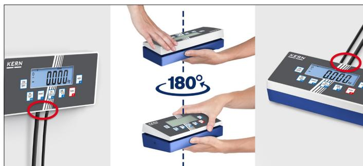
Praktisches Flip/Flop-Auswertegerät: vielseitig positionierbar z. B. freistehend oder an die Wand geschraubt (optional). Durch Drehen der oberen Gehäuseschale kann der Winkel des Displays sowie die Ausleitung der Kabel bestimmt werden. Factory Option gegen Aufpreis, Lieferzeit + 2 Arbeitstage, KERN KIB-M01, siehe *Zubehör*
