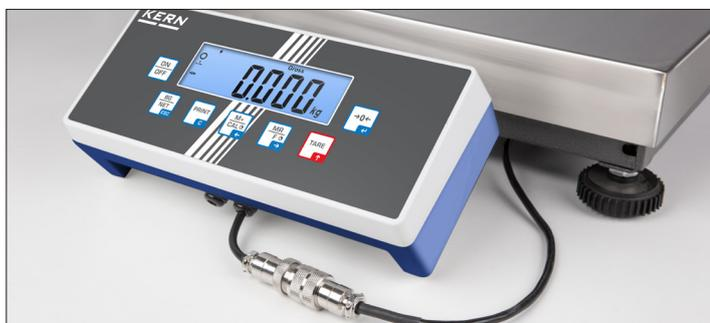
**1** Eichstecker, ermöglicht bei geeichten Waagen das Trennen von Auswertegerät und Plattform ohne die Eichung zu zerstören, z. B. für einen nachträglichen Einbau der Waage in einen Pack- und Versandtisch, Grubenrahmen etc. Bitte beim Kauf der Waage mitbestellen, siehe *Zubehör*
