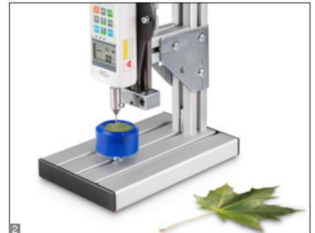
Manueller Prüfstand für präzise Zug- und Druckkraftmessungen im Bereich bis 100 N
