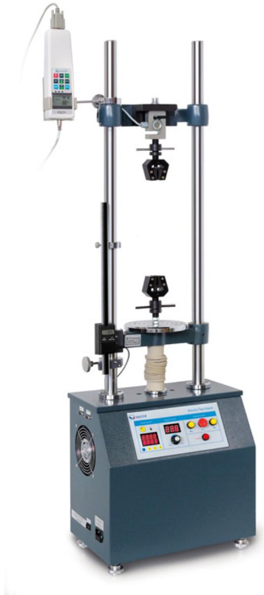
Prüfstand mit Elektromotor für Standardmessungen
