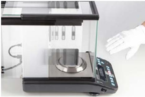
Automatische Schiebetüren – mit Hilfe von Sensoren steuerbar
