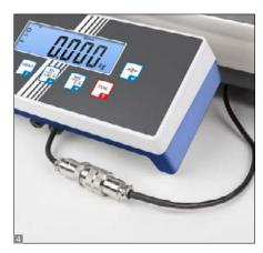
■ Eichstecker, ermöglicht bei geeichten Waagen das Trennen von Auswertegerät und Plattform ohne die Eichung zu zerstören, z. B. für einen nachträglichen Einbau der Waage in einen Pack- und Versandtisch, Grubenrahmen etc. Bitte beim Kauf der Waage mitbestellen
