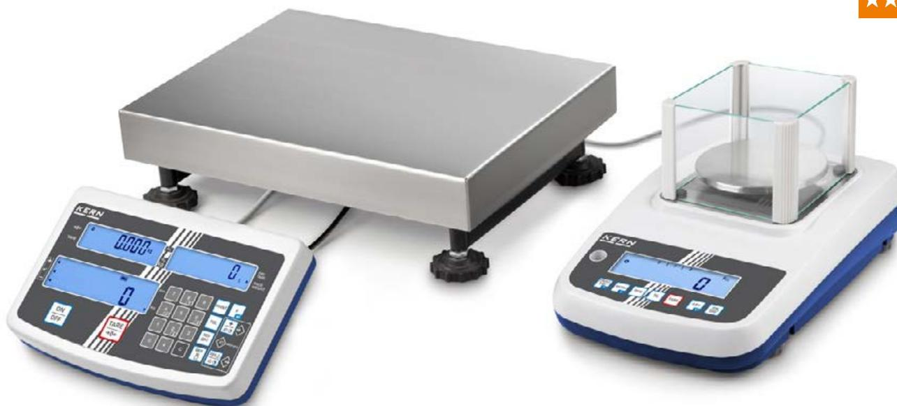
Hochauflösendes Zählsystem mit Eichzulassung zum Zählen kleinster Teile in großen Mengen, maximal anzeigbare Zählteile 999.999
