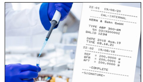
GLP/ISO-Protokollierung professionelles und ausführliches GLP-Protokoll, damit ist die Waage vollständig konform zu den entsprechenden Normanforderungen gemäß ISO, GLP und GMP
