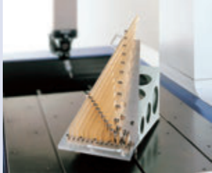
Bei der Maschinenabnahme eingesetzte Normale mit gegen „Null“ tendierender Wärmeausdehnung.
