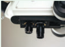
Objektivwechsler in Schiebeausführung für 2 Objektive (Werksoption)
