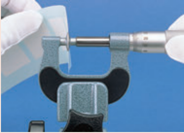
169-101 mit vollflächigen Messflächen
