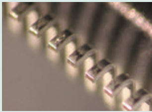
Beispiel: Höhe der Kontakte eines QFP
