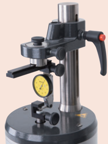
Kalibrierung von Fühlhebelmessgerät mit optionalem Zubehör
