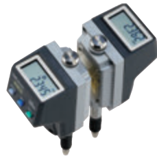
Flexible Einbaumöglichkeit durch umschaltbare Orientierung der Anzeige
