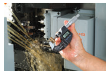
Hohe Beständigkeit gegen Wasser und Staub IP65
