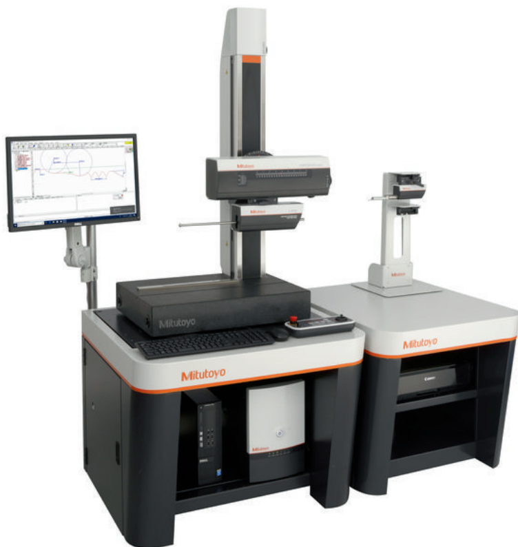
Formtracer Avant FTA-D4000 mit Schwingungsabsorbierer, Monitorarm und Beistelltisch
