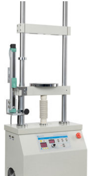
Motorisierter Prüfstand inkl. Längenmesssystem LD
