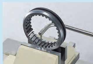
Belső fogazat mérése
